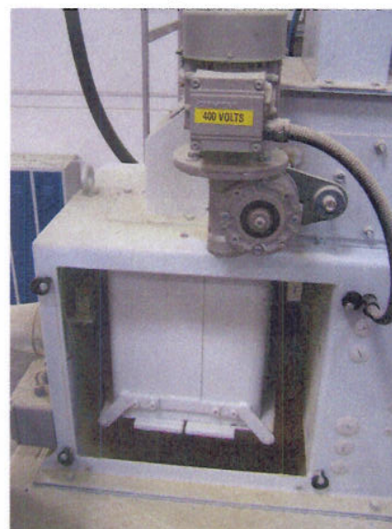
Vaga Paglierani NE-N manjeg kapaciteta, montirana iznad uređaja za uvrećavanje.
