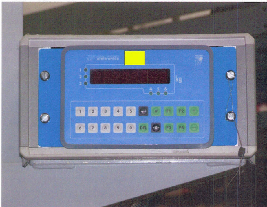
Prednja strana elektroničkog upravljačko pokaznog uređaja s položajem godišnjeg ovjernog žiga u obliku naljepnice i zaštitom od neovlaštenog pristupa.
