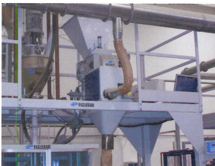
Vaga Paglierani NE-N manjeg kapaciteta, montirana iznad uređaja za uvrećavanje.
